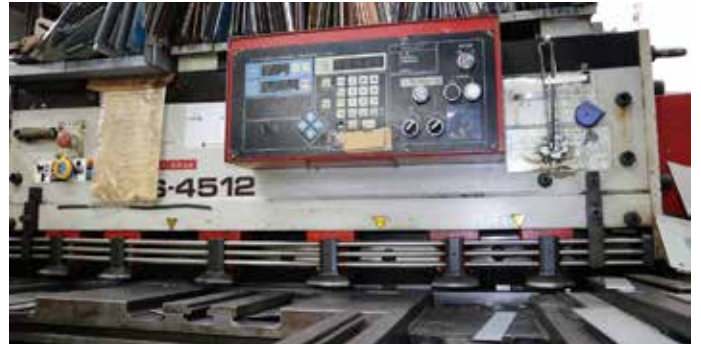
(上) 曲げ加工機：金属板を曲げる。 (下) セン断機：金属板を切る。
